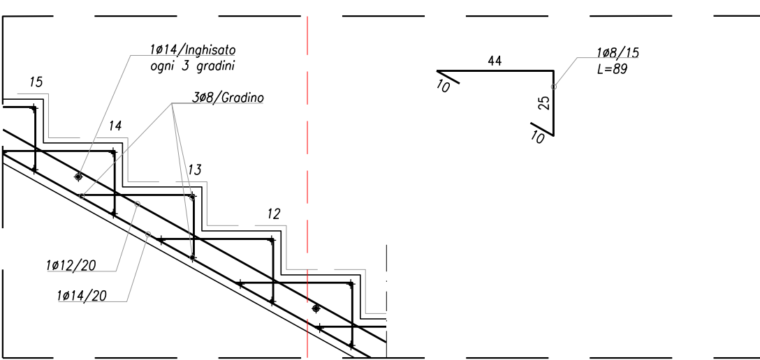
DETTAGLIO 01 - ARMATURA GRADINI SCALA 1:20
